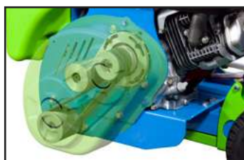
Transmisión POLY-V que reduce el patinamiento y la pérdida de potencia.
