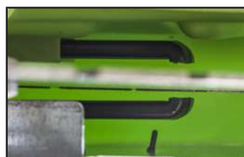
Horquilla de refrigeración para ambas caras del disco.
