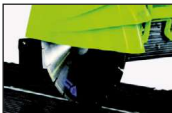
Protección abatible garantizando siempre la máxima altura de corte.
