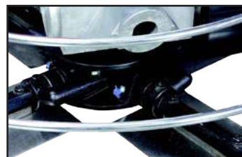
Brazos de palas provistos de engrasadores para un mejor mantenimiento.
