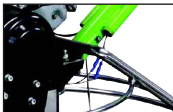
Brazo desmontable con estructura tri-tubo, cables eléctricos y acelerador.
