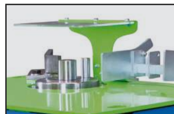
Pantalla curvada antiproyecciones.
