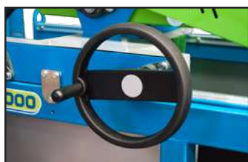
Avance manual accionado por volante.
