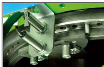
Sensores inductivos IP65. No les afecta la suciedad ni el agua.
