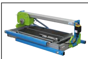
Patas plegables para mayor comodidad en transporte y almacenaje.
