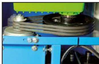
Novedoso sistema tensor de correas motor, más fácil y rápido.
