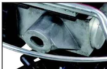
Alojamiento en reductor para barra de desplazamiento y transporte.
