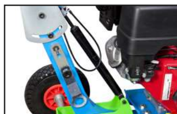
Sistema de elevación mediante amortiguador de gas.
