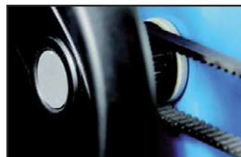
Avance del corte mediante correa de transmisión dentada.
