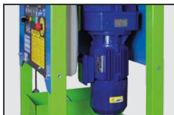
Motorreductor (0% pérdida de potencia).
