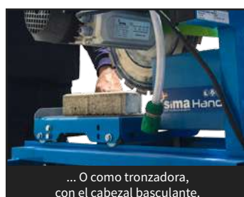
Sistema de circulación de agua para corte húmedo.
