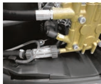
Sistema de amortiguación de vibraciones SDS
