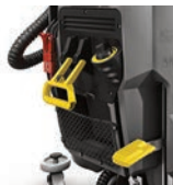
Presión del cabezal de cepillos ajustable
