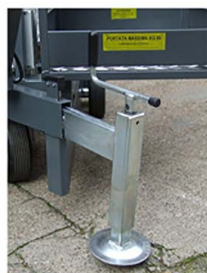
Equipado con 4 estabilizadores extraíbles para total estabilidad
