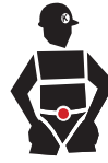
AMARRE VENTRAL Apto para trabajos en suspensión EN813 No puede usarse como anticaídas
