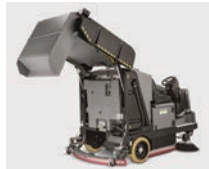
Vaciado en alto hidráulico
