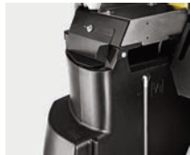
Depósitos agua y gasoil
