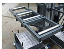
Bandeja con rodillos para introducir el féretro en el nicho
