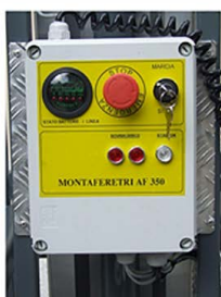
Cuadro de mando con parada de seguridad y arranque con llave
